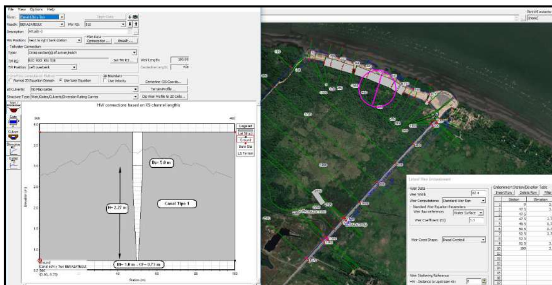
Figura 57: SP- 2A – Esquema modelado – Canal de Cruce Terraplén progr. 510 m – Canal Tipo 1 – Recorte de Tablestaca a cota 0.73 m
