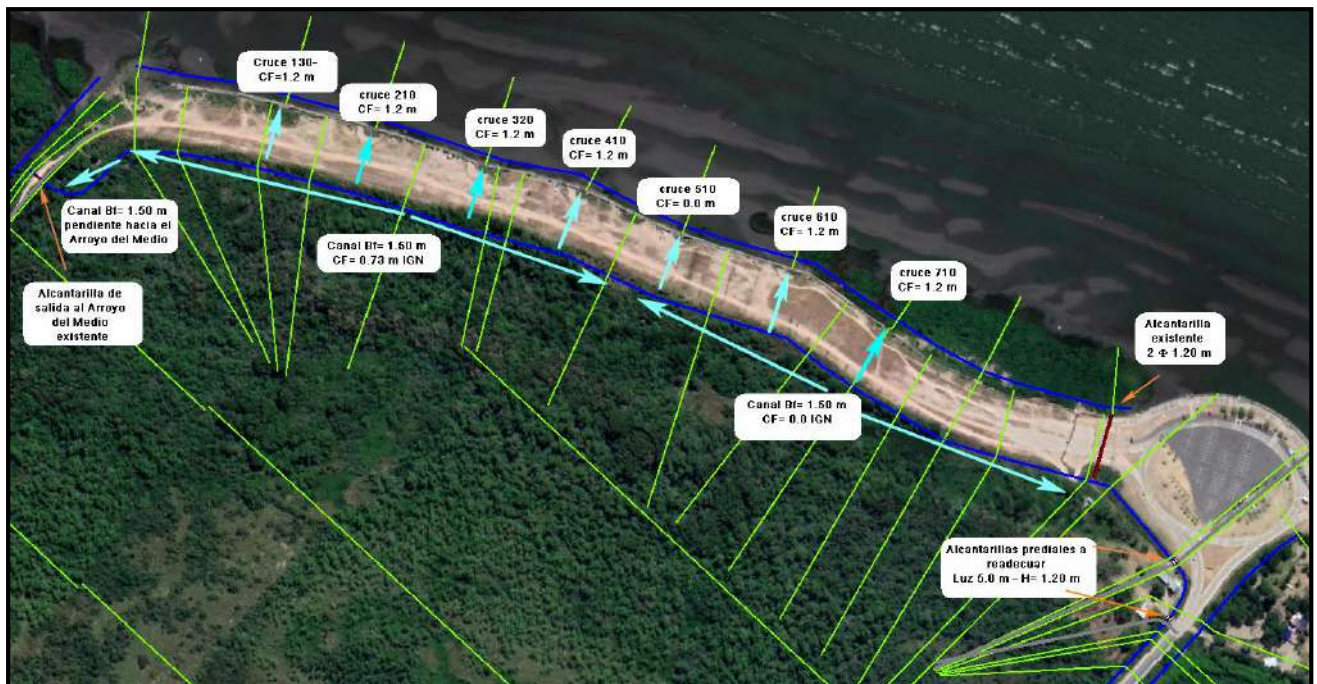
Figura 62: SP- 2E – Esquema modelado Obra a Ejecutar
