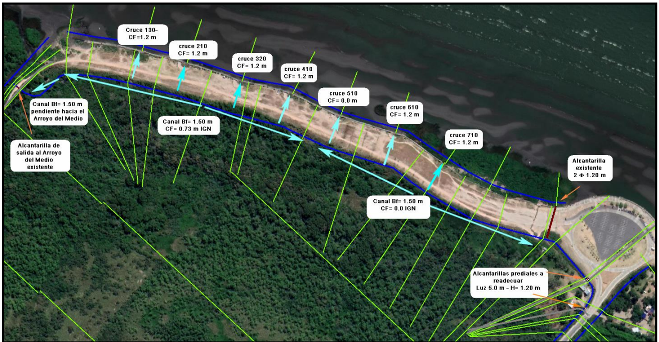
Figura 62: SP- 2E – Esquema modelado Obra a Ejecutar
