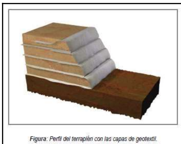
Figura 9: Perfil del terraplén ejecutado
