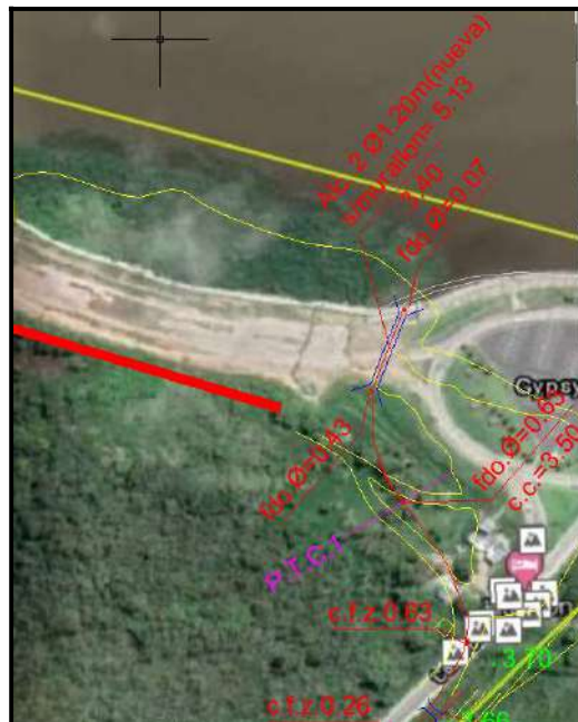
Figura 38: Alcantarilla existente extremo rotonda
